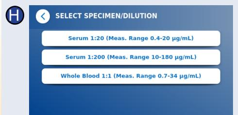
Certaines méthodes de test peuvent nécessiter la sélection du type de prélèvement et/ou de la dilution de l'échantillon.
