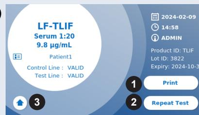
Le résultat s'affiche sur l'écran de résumé des résultats. Les résultats peuvent être imprimés (O, 1), ou une nouvelle mesure peut être démarrée en utilisant les mêmes réglages (O, 2) ou revenir à l'écran d'accueil (O, 3).
