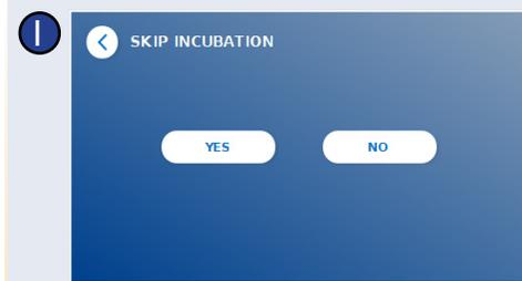
En la pantalla «SALTAR LA INCUBACIÓN», pulse «SÍ (YES)» si el tiempo de incubación se controla mediante un cronómetro externo. Pulse «NO (NO)» si el tiempo de incubación debe ser medido por el lector.
