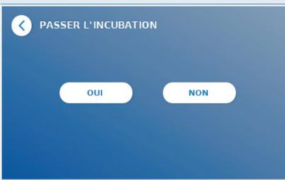
Sur l'écran PASSER L'INCUBATION, appuyer sur « OUI », si la durée d'incubation est commandée par un minuteur externe. Appuyer sur « NON » si la durée d'incubation doit être mesurée par le lecteur.
