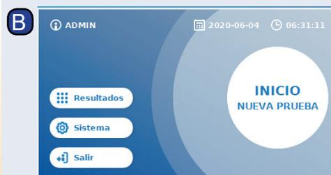
Para iniciar una nueva medición, pulse «INICIO NUEVA PRUEBA».
