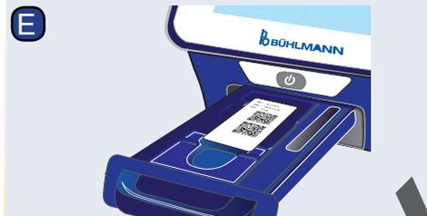
Abra la bandeja y coloque la tarjeta de código de barras en el soporte como se muestra.
