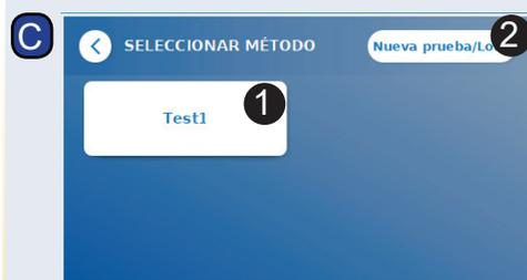
Seleccione una de las pruebas disponibles (C, 1) y proceda con el paso D, o pulse «Nueva prueba/Lote» (C, 2) para introducir un nuevo método y continúe con el paso E.
