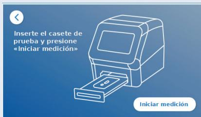
Cierre la bandeja y pulse «Iniciar medición» una vez que el tiempo de incubación haya terminado. El lector medirá el casete de prueba (N2).
