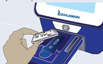
Abra la bandeja y coloque el casete de prueba en el soporte como se muestra (L2)...
