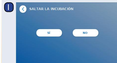
En la pantalla «SALTAR LA INCUBACION», pulse «SÍ» si el tiempo de incubación se controla mediante un cronómetro externo. Pulse «NO» si el tiempo de incubación debe ser medido por el lector.
