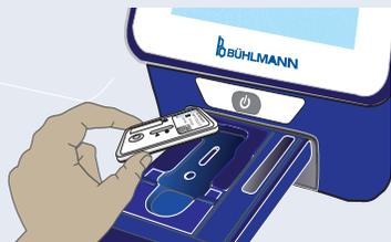
Abra la bandeja y coloque el casete de prueba en el soporte como se muestra (L3).
