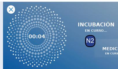
El lector realizará la prueba, comenzando con la incubación específica de la prueba (N1), seguida de la medición del casete de prueba (N2).
