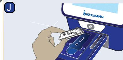
Abra a gaveta e coloque o cassete do teste no suporte de cassete, conforme indicado...
