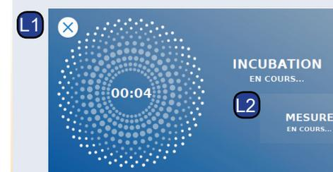
Le lecteur exécute à présent le test, en commençant par l'incubation spécifique au test (L1), suivie de la mesure de la cassette test (L2).
