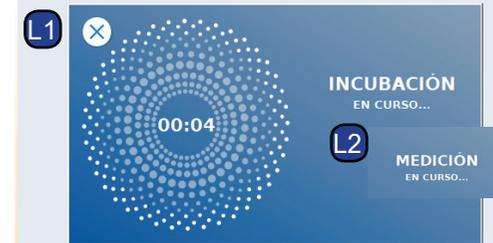
El lector realizará la prueba, empezando por la incubación específica de la prueba (L1), seguida de la medición del casete de prueba (L2).
