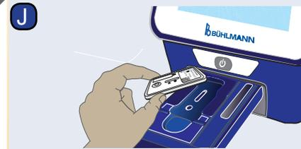
Abra la bandeja y coloque el casete de prueba en el soporte como se muestra, ...
