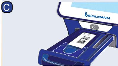
Abra la bandeja y coloque la tarjeta de código de barras en el soporte como se muestra.
