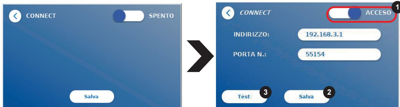
Premendo **Test** (2) è possibile verificare se la connessione a Quantum Blue® Connect Software è stata stabilita correttamente. Sul display del lettore compare un messaggio che conferma la riuscita dell'operazione (Figura 9).
