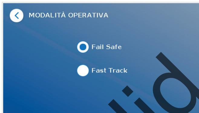
La modalità Fail Safe Mode (vedere il capitolo [9.2 Avvio di un test in Fail Safe Mode](#)) è l'impostazione predefinita e richiede sempre la lettura della scheda con codice a barre. Quando si avvia la misurazione, il lettore Quantum Blue® Reader completa innanzitutto il tempo di incubazione specifico per il test e poi esegue la scansione della cassetta del test.
